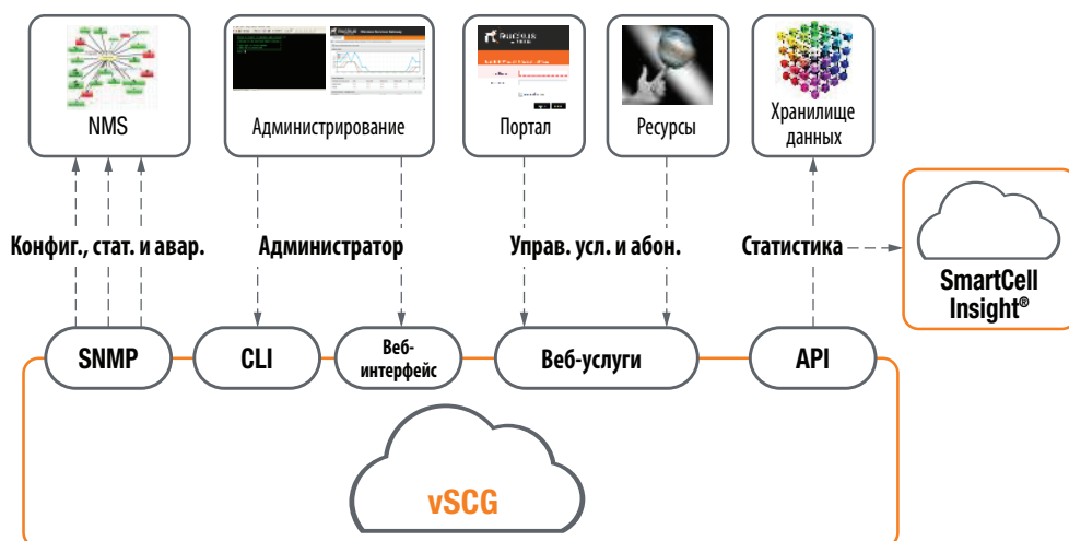
Рисунок 2: Встроенная система EMS обеспечивает удобную полнофункциональную поддержку FCAPS и может быть легко интегрирована в существующие системы OSS/BSS.
